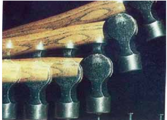
(4-1) شکل، څټک یوه قوه پرمخ واندوي اومخ هم د څټک د قوي په خلاف لوري، پرمخک قوه واندوي.
